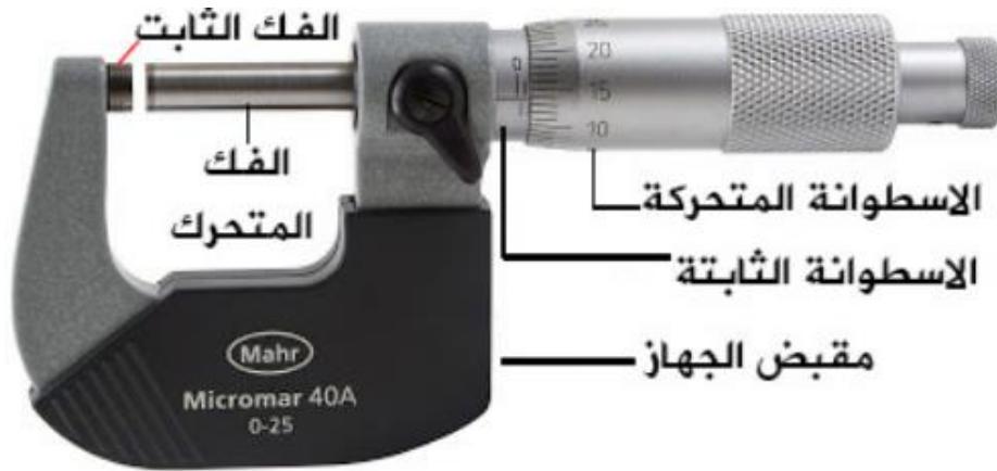
شكل رقم ٢٥: تركيب الميكروميتر
