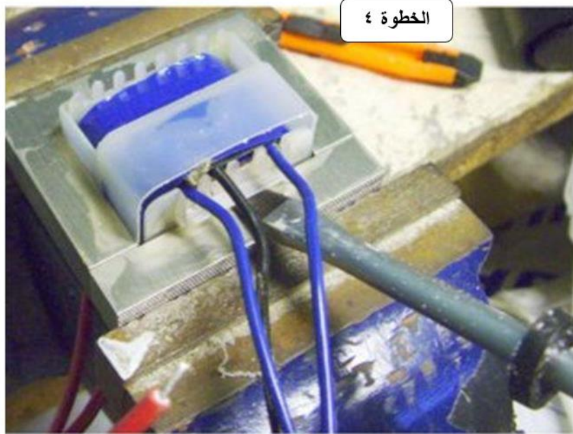
شكل رقم ٢٠: استخدام المفك لنزع الصفائح
