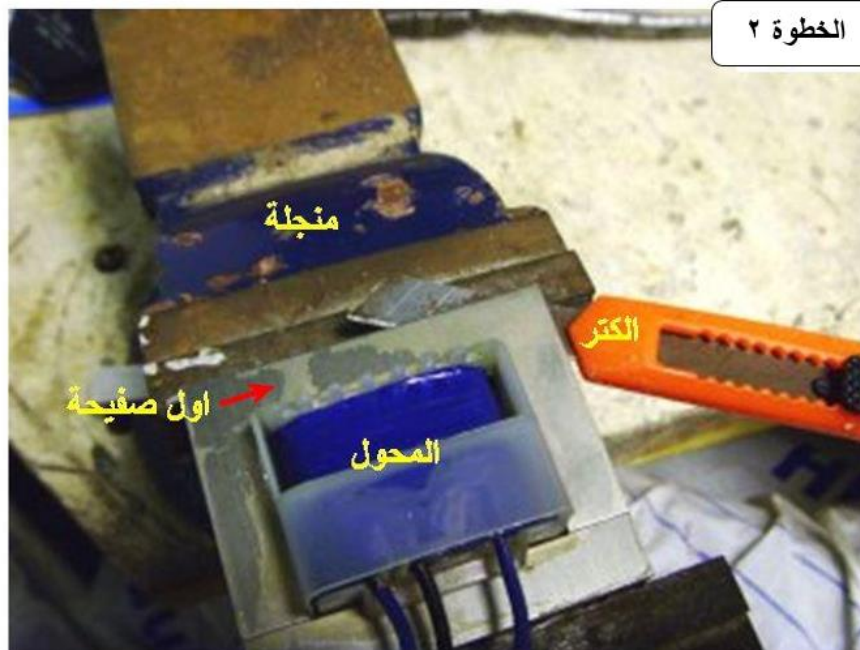
شكل رقم ١٨: فك الصفحة الأولى باستخدام القاطع (Cutter)
